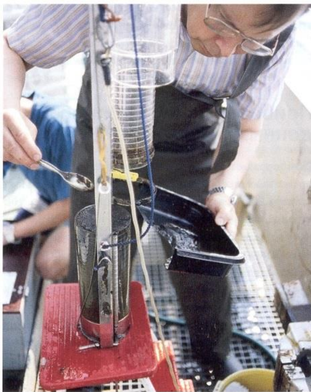
Прибор "Лимнос" предназначен для отбора проб донных отложений. Представлен момент разделения колонки
